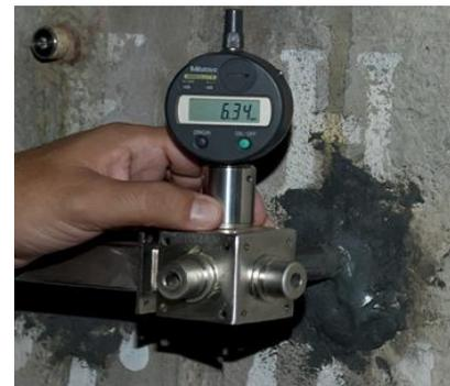
Figura 8 – Extensômetro de haste
