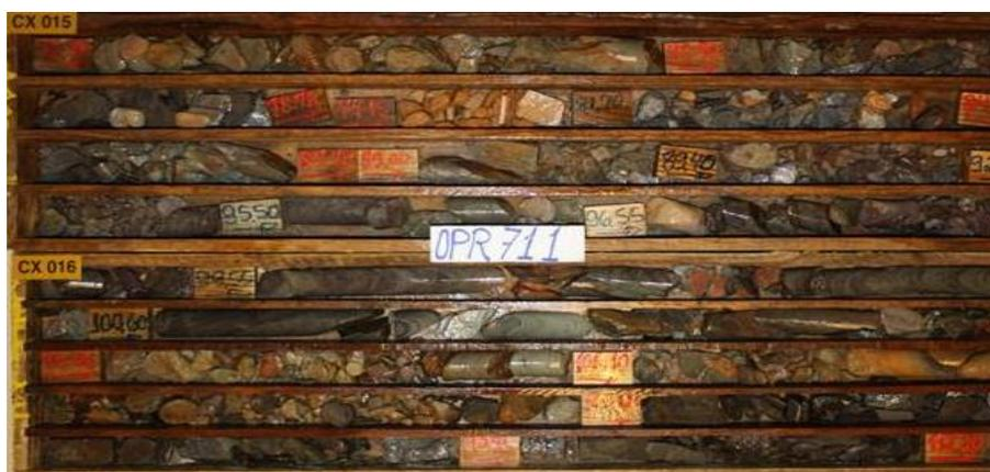
Figura 11 - Testemunhos de sondagem Nível 420 GTN
