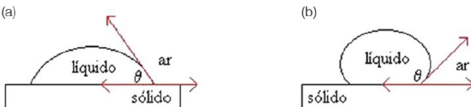
Figura 1- superfície hidrofílicas a) apresentam ângulo de contato menores que  $90^\circ$ , enquanto superfície hidrofóbica b) apresentam ângulos maiores que  $90^\circ$ .
