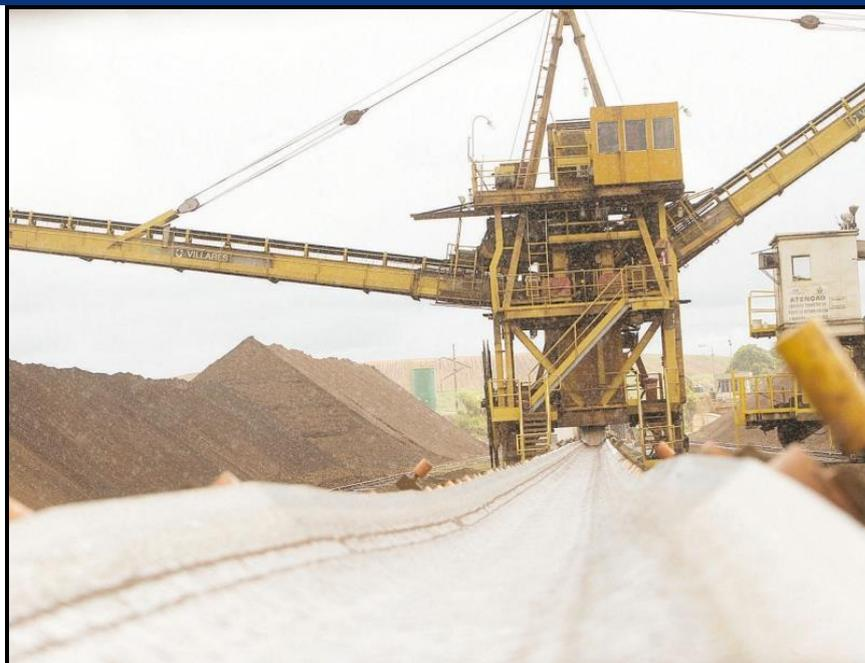
Figura 2 - Pilha de Minério sendo formada.
