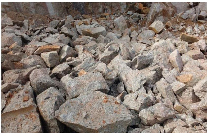
Figura 7 - Matacos provenientes do desmonte de rocha da mineração.
