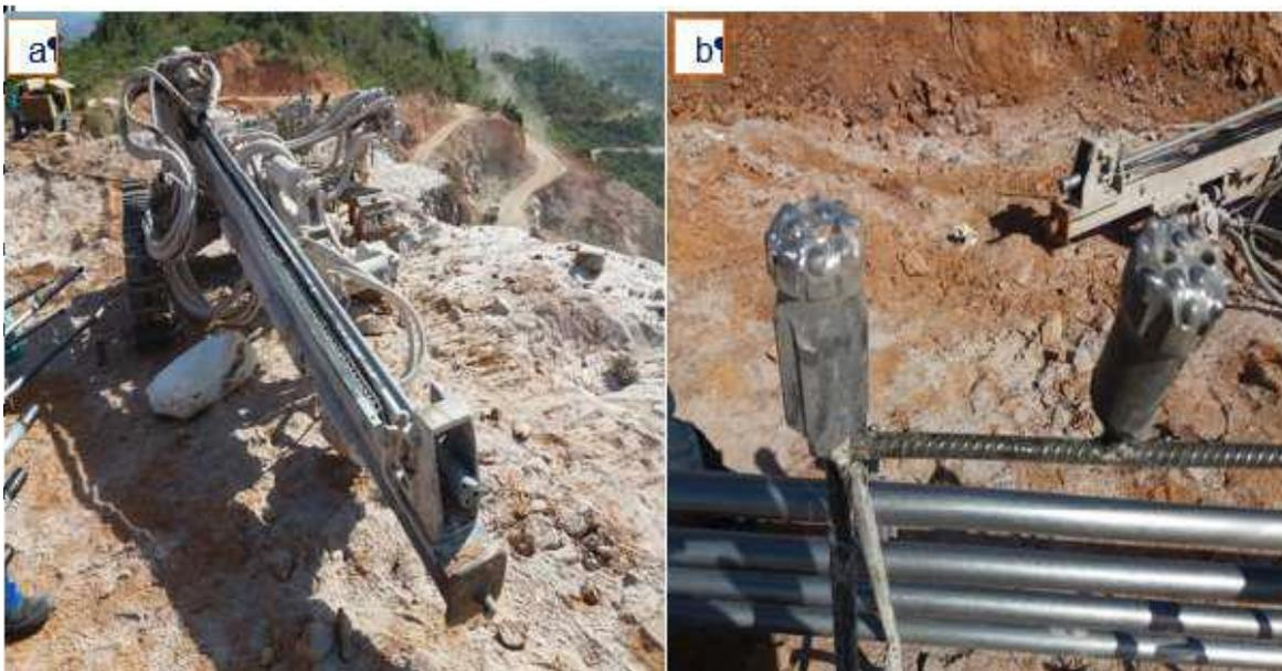
Figura 4 - a) Perfuratriz pneumática percussiva; b) Bits de perfuração. Fonte: Arquivo pessoal, 2019.
