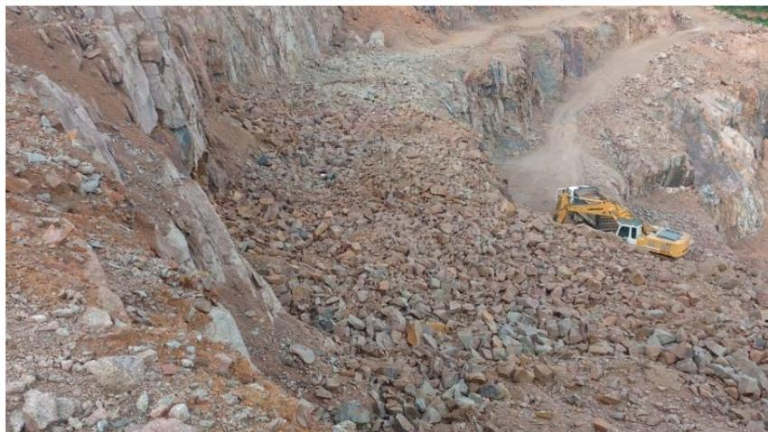
Figura 8 - Resultado do desmonte da malha do caso 3.
