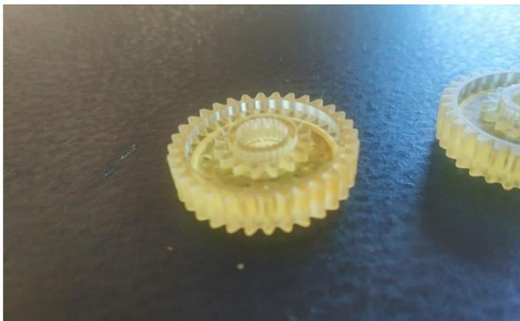
**Figura 2** – Engrenagem de servo impressa em resina
