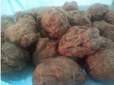
**Figura 2** – Polpas de fibras de celulose.
