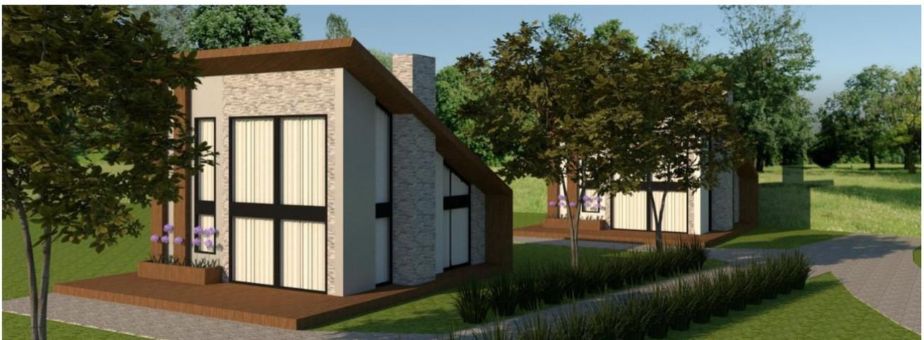
aparente com inclinação de 50%, revestimento em madeira de eucalipto tratada e pedra ardósia.
