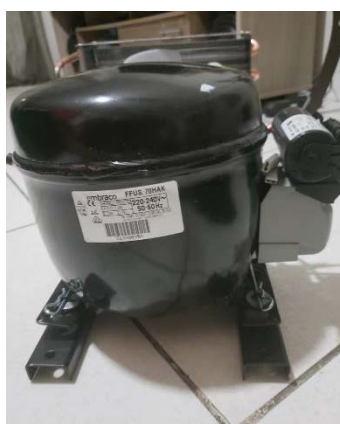
Figura 4 – Compressor hermético FFUS 70HAK 220V 60Hz R-134A
