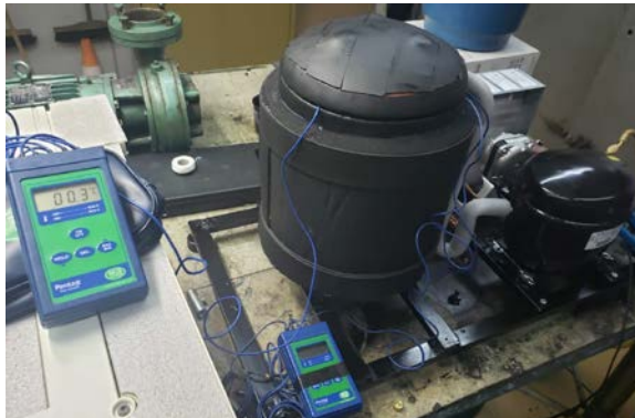
Figura 19 – Recolhedora de gás R-22 por diferença de pressão
