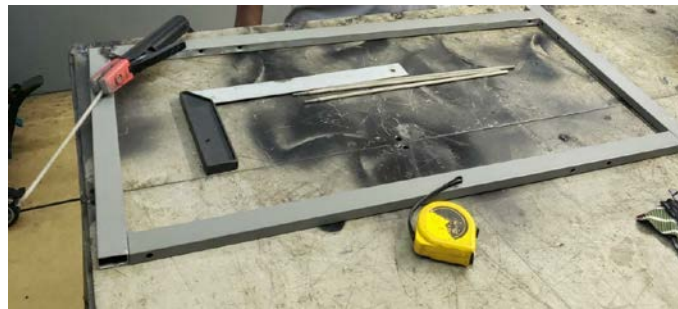
Figura 10 – Base estrutural do protótipo 810 x 420 (c x l) mm
