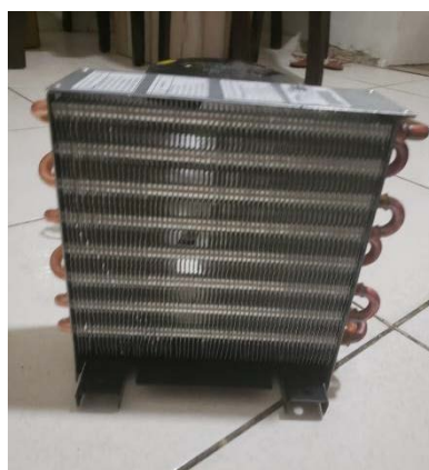
Figura 5 – Condensador 1/4 hp tubo de cobre e aleta de alumínio
