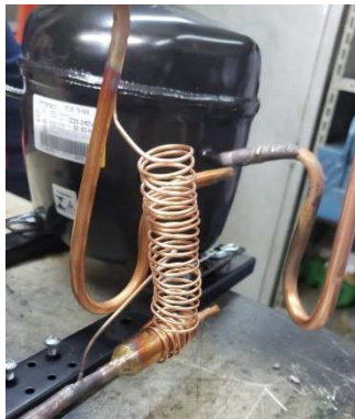
Figura 9 – Tubo capilar de cobre 3m x 0,031mm
