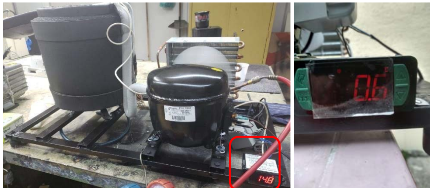
Figura 16 – Automatização do sistema. a) fixação do controlador full gauge . b) imagem ampliada do dispositivo durante realização de teste
