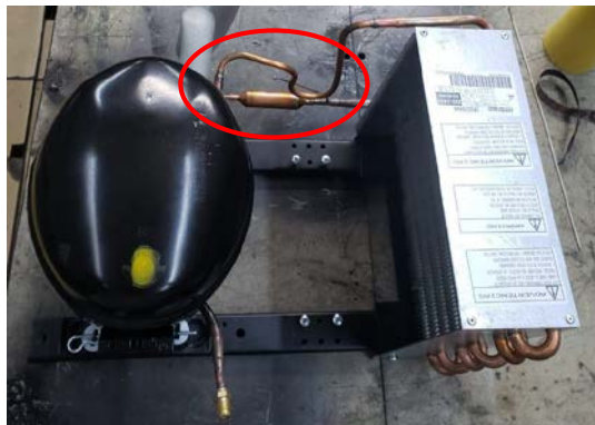
Figura 7 – Filtro secador 90 mm sílica e rabicho
