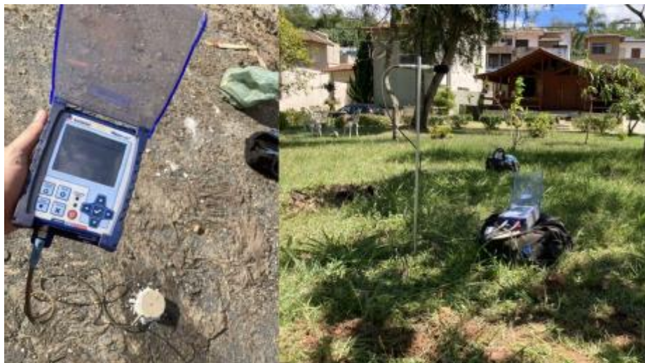
Figure 2 - Sismógrafos utilizados para análise de vibrações de desmorte por explosivos
