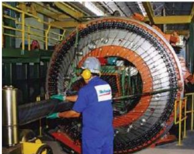
Figura 11: Armadura de tração sendo aplicada na linha flexível
