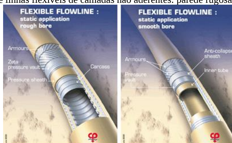
Figura 13: Tipos de linhas flexíveis de camadas não aderentes: parede rugosa e parede lisa
