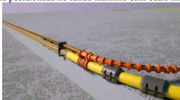
Figura 14: Flowline posicionada no fundo marinho com outra linha acoplada
