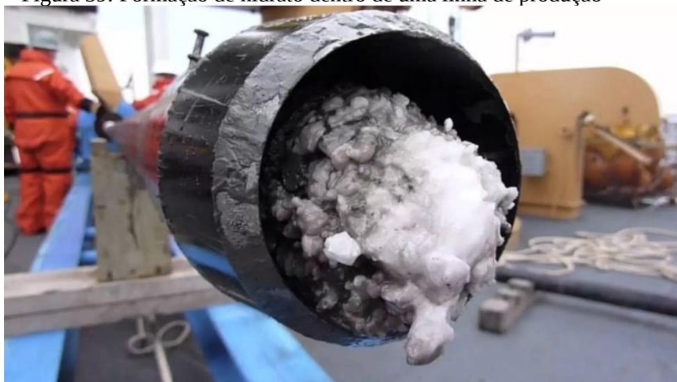
Figura 39: Formação de hidrato dentro de uma linha de produção
