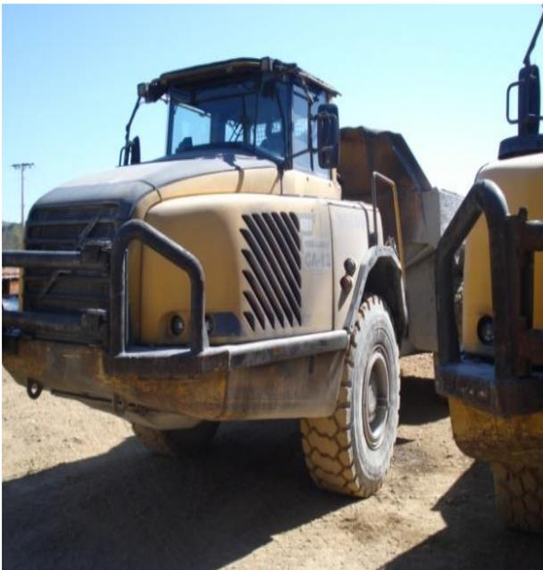
Figura 1 - Caminhão Volvo A-30 utilizado para escoamento do minério por rampa. Fonte: O autor
