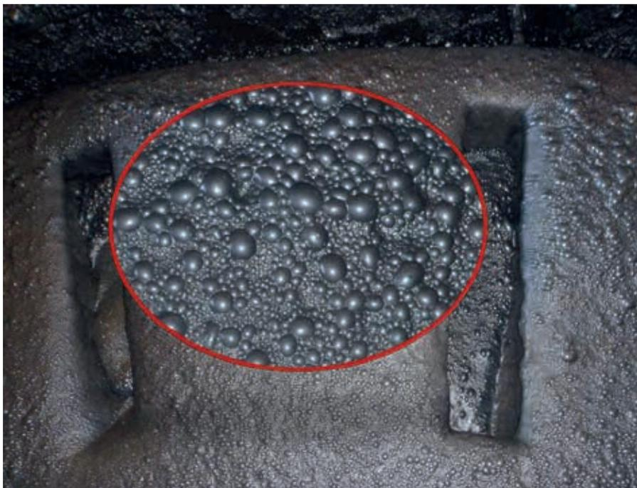
Figura 5: Camada de espuma da flotação durante o uso do sulfeto de sódio.
