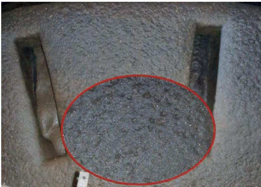
Figura 2: Camada de espuma da flotação antes do uso do sulfeto de sódio.
