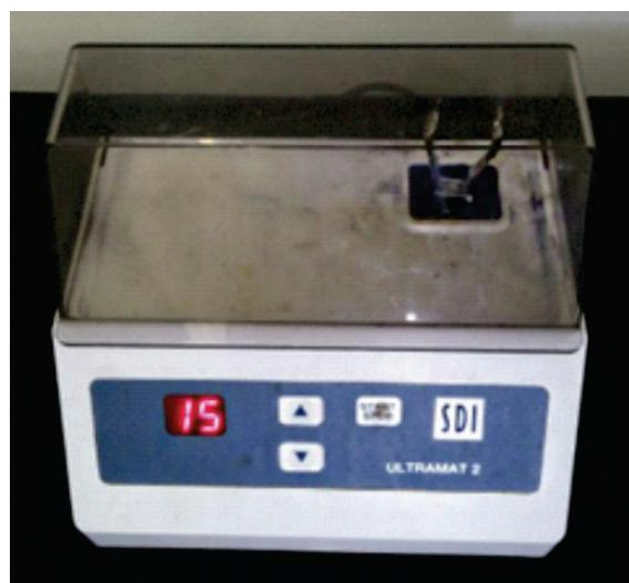
Figura 3. Amalgamador e seu tempo máximo de 15 segundos
