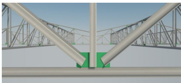
Figura 19: Ligação através de soldagem direta no modelo virtual. Fonte: acervo particular dos autores.
