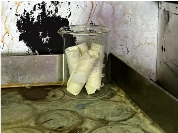
Imagem-2: Amostra na estufa a 105°C por 1 hora.
