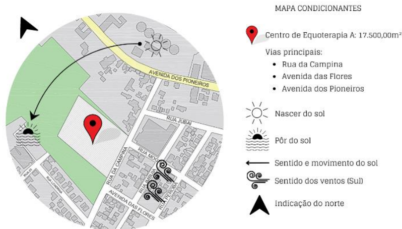
Figura 2 – Análise de condicionantes
