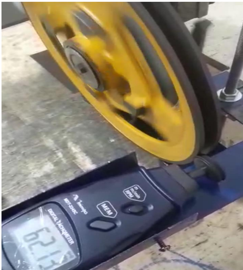
Figura 4 – Calibração do Limitador de velocidade na bancada de testes
