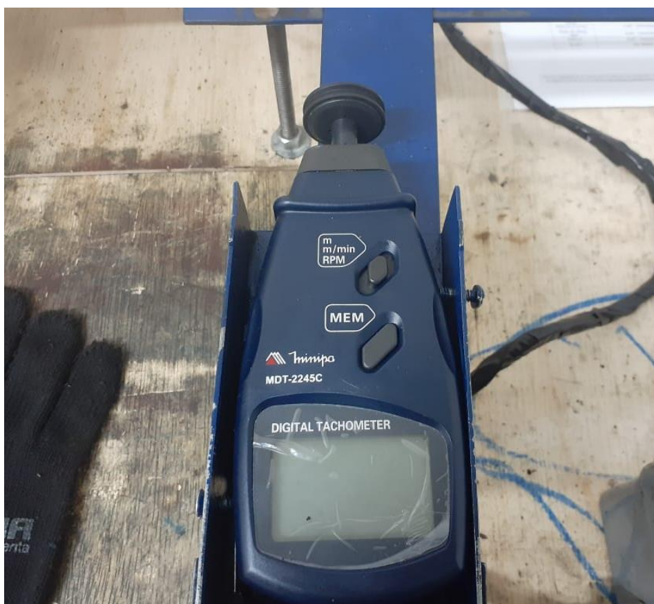
Figura 8 – Aparelho tacômetro digital da marca MINIPA modelo MDT-2245C calibrado:
