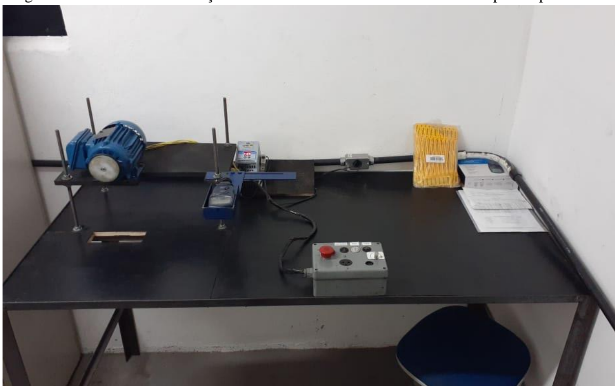
Figura 7 – Bancada de calibração de limitadores de velocidade finalizada pronta para testes.
