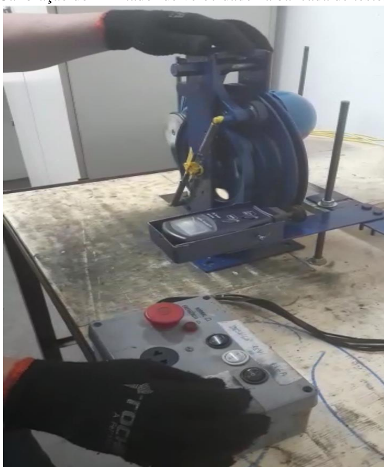
Figura 6 – Calibração do Limitador de velocidade na bancada de testes construída.
