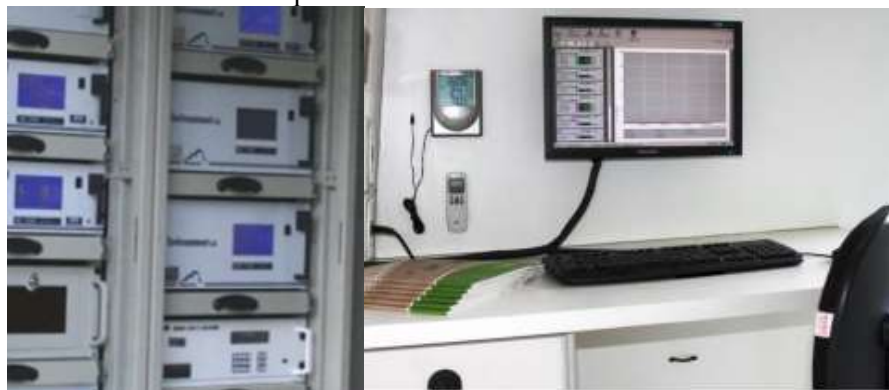
Figura 3 - Equipamentos de quantificação de poluentes presentes no ar e Sistema de aquisição dos dados de qualidade do ar monitorados
